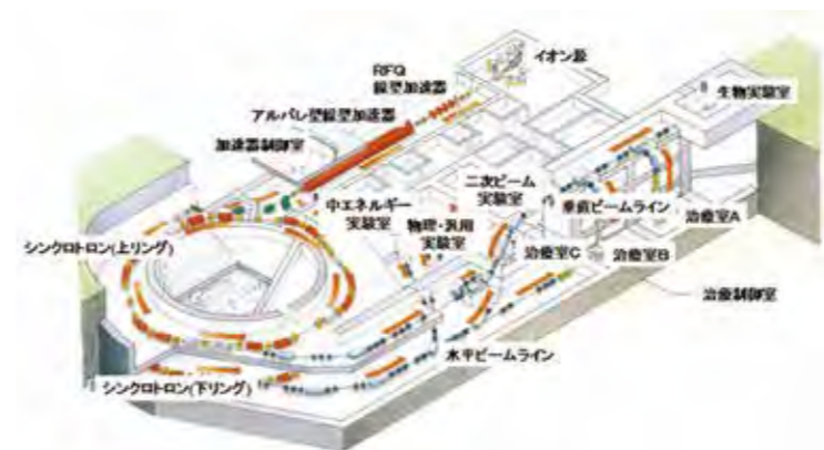
図 2 放医研が 1993 年に建設した世界初の重粒子線がん治療装置 HIMAC (大きさ 120 m x 60m)。
