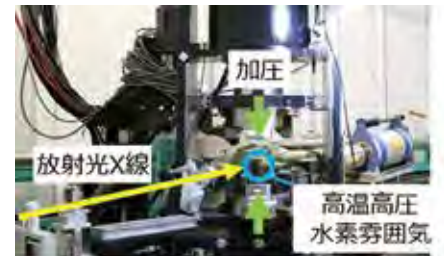
図3 放射光を用いた高温高圧水素雰囲気下の観測装置
