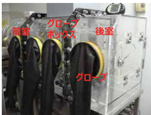
搬出入接続装置
