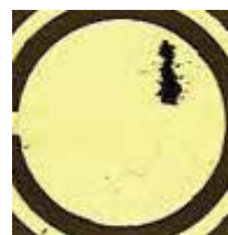
炭化ケイ素(SiC)金属-酸化膜-半導体(MOS)デバイスの破壊箇所の顕微鏡写真
