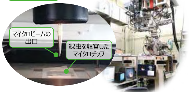
イオンマイクロビーム照射装置（右）を用いた線虫へのマイクロビーム局部照射。マイクロチップの厚さをイオンビームが透過可能な1mm以下としたことで、ヒットしたイオンの正確な検出と照射後の線虫の観察を実現。
