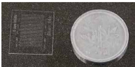
厚さ300 μmの線虫収容保定用PDMSマイクロチップ（左）。
