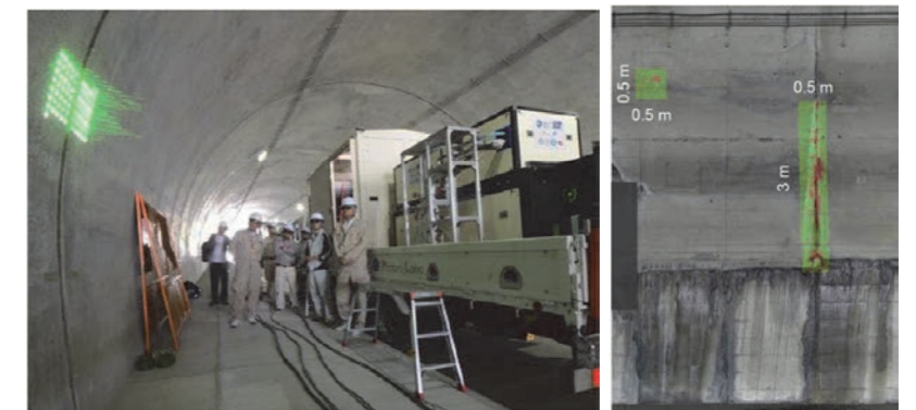
図6. トンネルでの実証実験 (左) と専門技術士による判定結果との比較 (右)
