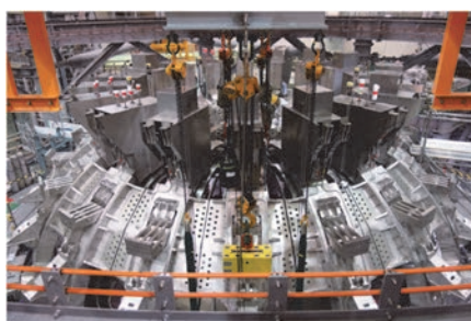
図2. JT-60SAに最終セクターを組み込んだところ
