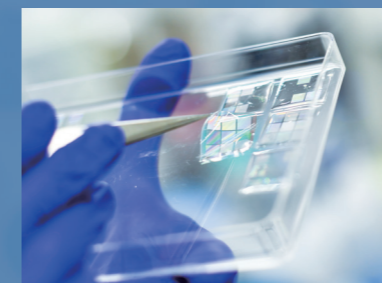
ハイドロゲル表面を微細加工するための鋳型
