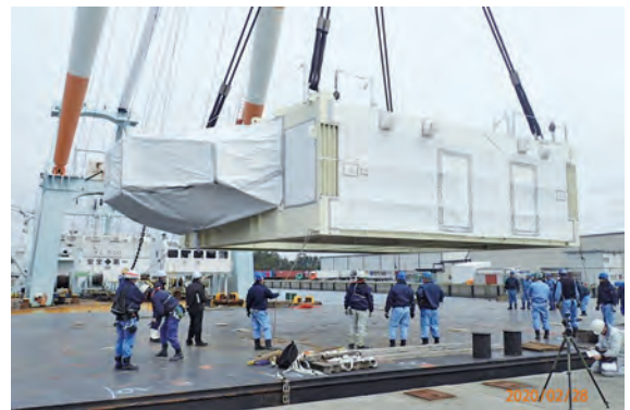
完成した TF コイル一号機を 南フランスの ITER サイトに向け搬出
