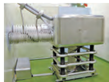
イオン注入装置
