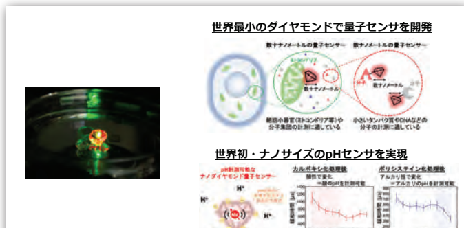
図2 ダイヤモンド NV センター ダイヤモンド結晶（炭素の格子）中の、不純物の窒素 (N) とその隣の穴（格子欠陥、V）のペアを NV センターといいます。NV センター内のスピン量子は、外部を鋭敏に感じ取る量子センサとして利用できます。
