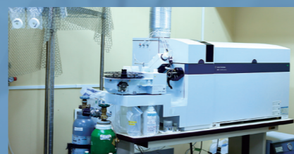
生体試料中のα線核種の定量のために使用する質量分析装置（四重極型ICP-MS）
