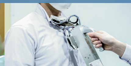
甲状腺中のヨウ素を高感度で安定して測定できるハンドヘルドモニタ。こうした計測機器も開発しています。
