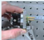
指先ほどの大きさの イッテルビウム 添加ヤグレーザー
