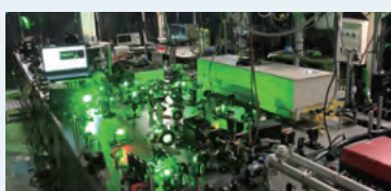
① 繰り返し10Hz 10TW級高強度レーザー
