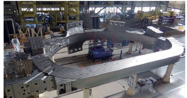
完成したトロイダル磁場コイル ©ITER Organization
