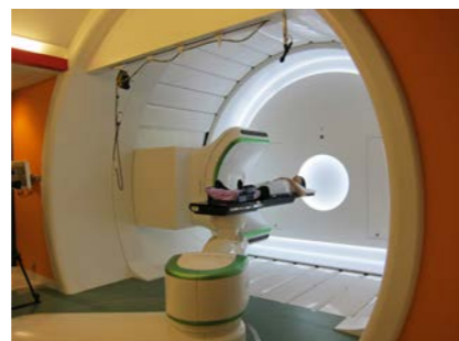
写真2：回転ガントリー照射室（山形大学提供）
