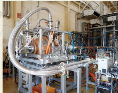
▲日本で行われている性能試験の様子 マイクロ波の出力を水温の変化で確認▶
