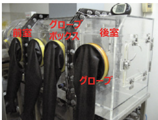
搬出入接続装置
