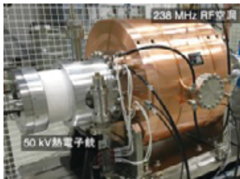
図2. 新しく開発した電子銃システム (500kVグリッド熱電子銃を使用)
