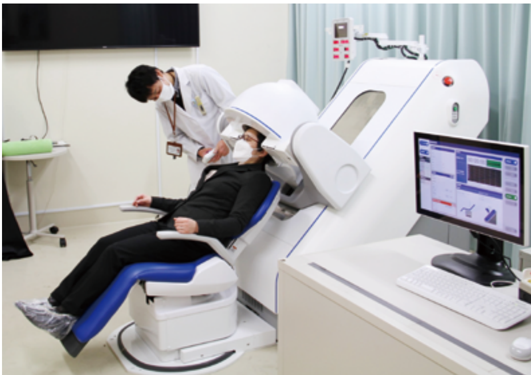
開発した頭部専用PET装置Vrainに患者さんが座り、検出器をセットしている様子(イメージ)
