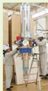
高周波加熱装置 ジャイロトロンと呼ばれる大電力ミリ波の発振管
