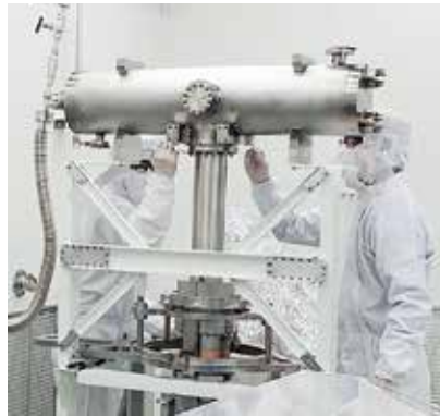
超伝導加速器空洞の組立
