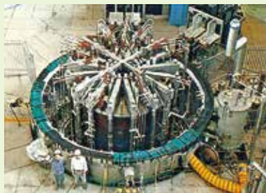
13テラ発生に成功したITER用超伝導モデル・コイル(外径3.6m)
