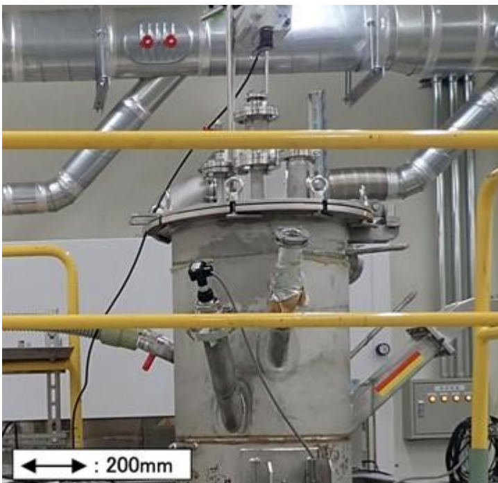
図) QST 六ヶ所研究所で実証試験に用いたマイクロ波加熱ベンチ装置
