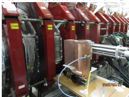
図5: フェーズドアレイアンテナをPANTA装置に設置
