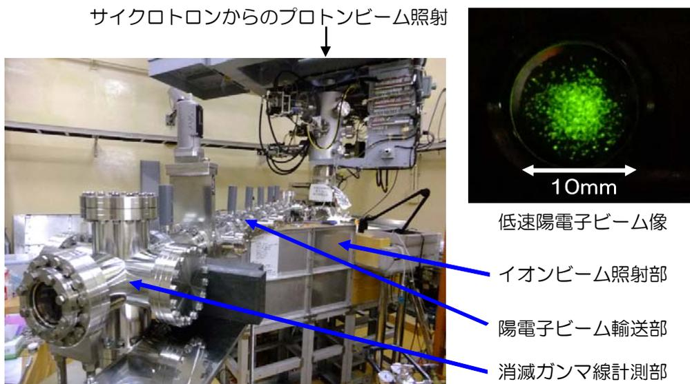
図2 開発したスピン偏極陽電子ビーム発生装置と、発生した陽電子ビーム像
