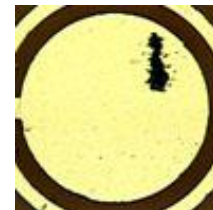
炭化ケイ素(SiC)金属-酸化膜-半導体(MOS)デバイスの破壊箇所の顕微鏡写真
